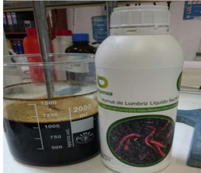
Tras esas 24 horas hacemos una separación fase líquida-sólida por decantación, en la decantación se separa un sólido o líquido más denso de otro fluido menos denso y que por lo tanto ocupa la parte superior de la mezcla. La decantación sólido-líquido se utiliza cuando un componente sólido se encuentra depositado en un líquido. Es necesario dejar reposar la mezcla para que el sólido se sedimente, es decir, descienda y sea posible su extracción por acción de la gravedad.
