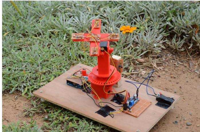
Nuestro principal objetivo que nos marcamos fue conseguir realizar un prototipo de seguidor de luz que consiguiera que una placa solar pueda producir más energía solar que cualquier placa fotovoltaica fija que nos encontramos en los tejados de las casas.
