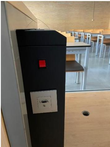
Si el sistema de sonido es como el de la foto, pulsaremos el botón rojo de encendido para conectar el sistema de audio.
