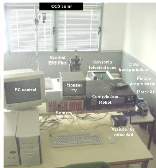
(a) Célula robotizada completa a adquirir
