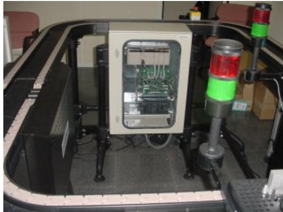
Figura 25. Sistema de transporte guiado.
