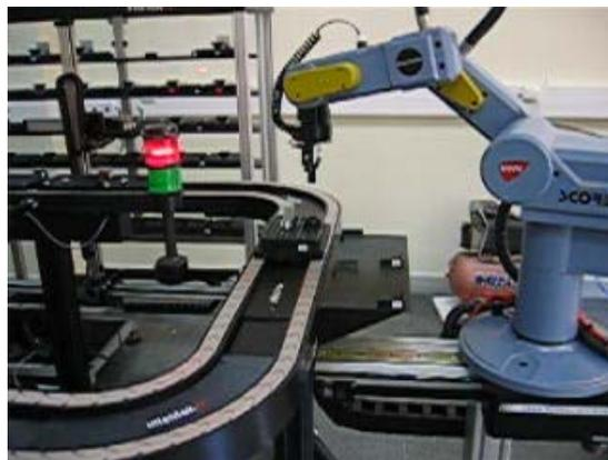
Figura 26. Robot manipulador SCORBOT ER-IX.
