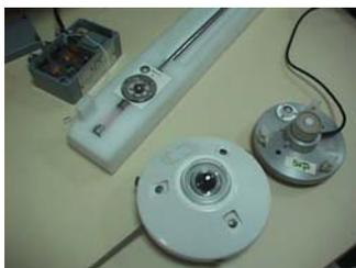
(a) Sensores de radiación y acondicionador de señal
