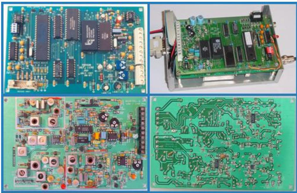
Figura 35. Sistemas empotrados y radiomodem de propósito específico
