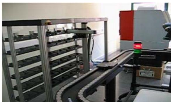
Figura 24. Sistema de almacenamiento automatizado.
