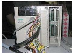
10 Automatas TSX Micro TSX3710 conectados por bus dXWAY
