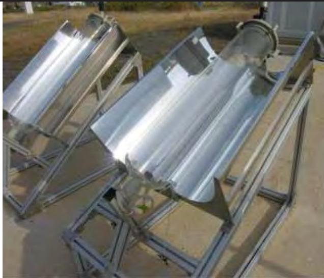
Detalle de un fotoreactor para desinfección solar de la PSA.
