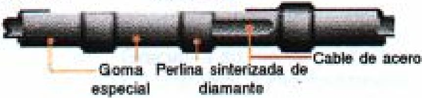
Dos tipos de montaje de los hilos para la extracción del mármol
