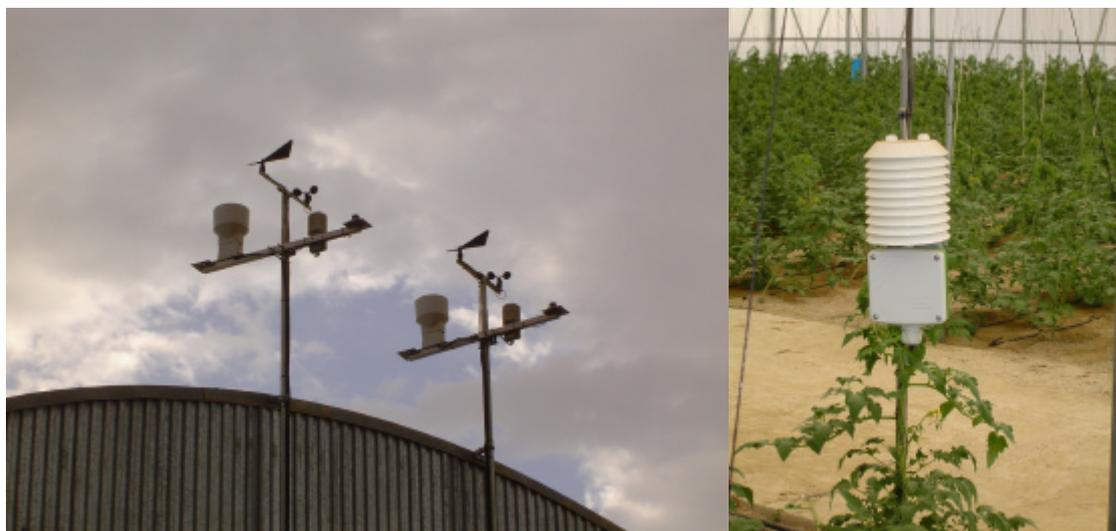
**Figura 9: Estación meteorológica en el exterior del invernadero y detalle de un sensor de temperatura y humedad relativa en el interior de un invernadero.**
