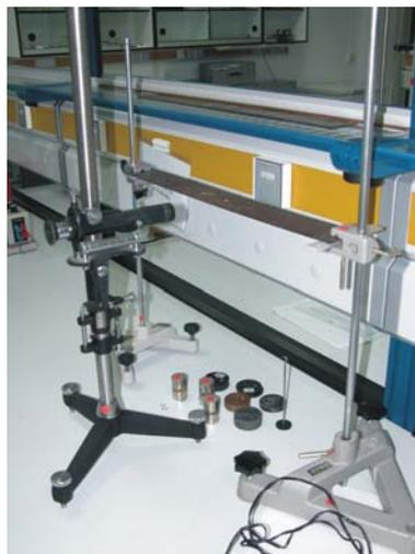
*Montaje experimental donde se aprecia la barra horizontal, las pesas y el portapesas y el catetómetro (en este caso) como dispositivo para medir la deformación.*
