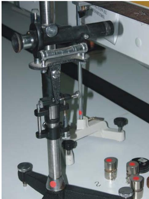
*Detalle de la mira telescópica del catetómetro.*
