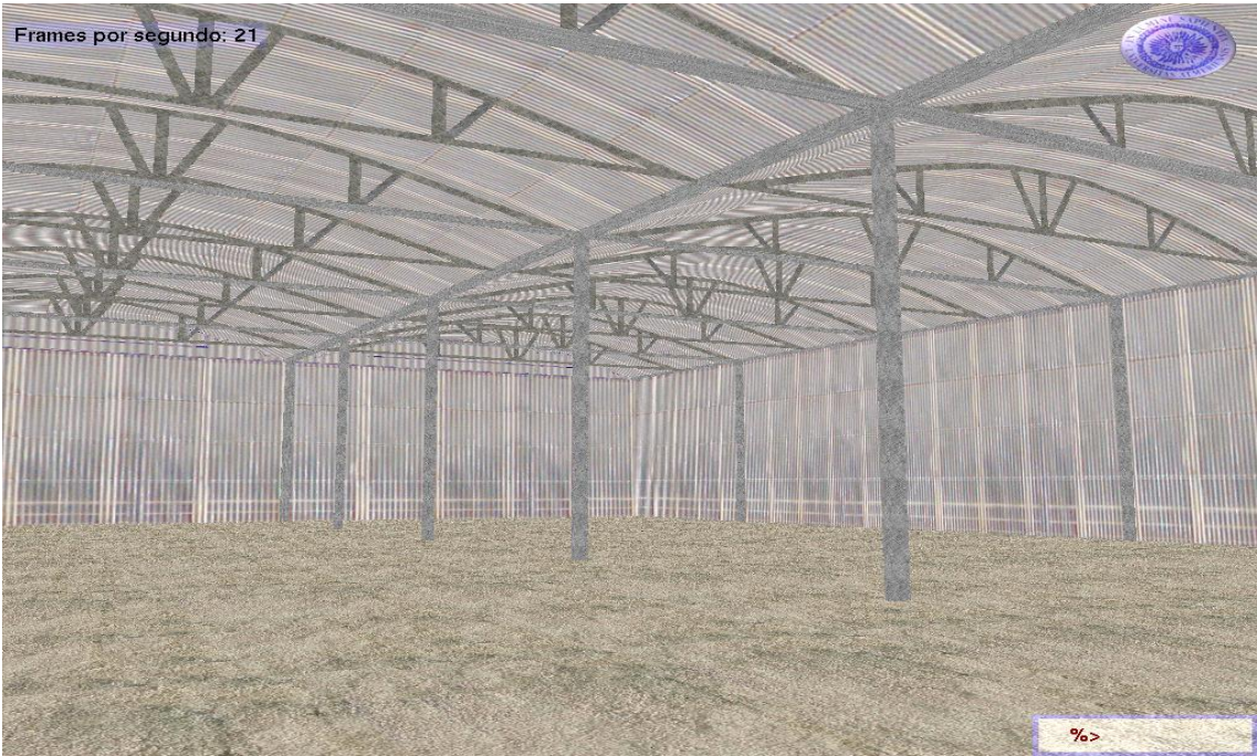
Invernadero multitúnel de policarbonato (interior)
