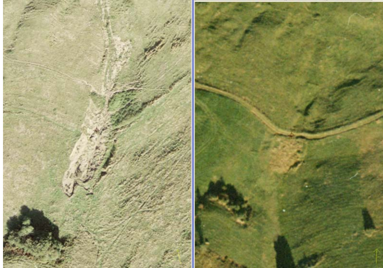
Figura 7. Evolución del deslizamiento en la zona 4 de Villafufre. Izq.: 2003, Dcha.: 1988
