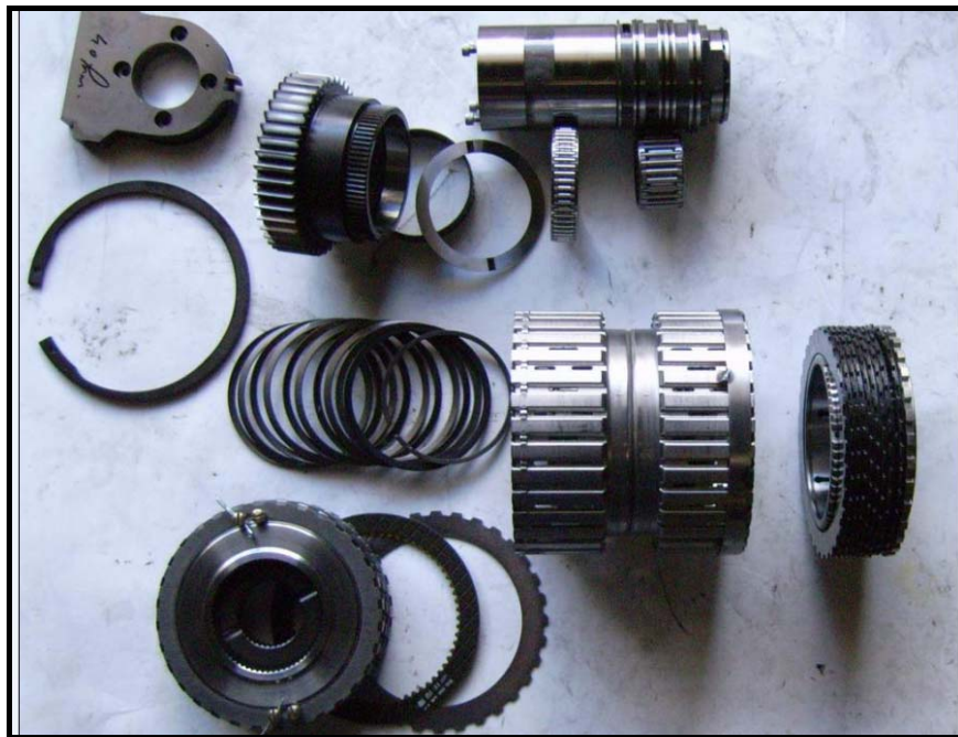
Fig. 7. Detalle de los componentes de una de las parejas de embragues multidisco. (Fuente propia)
