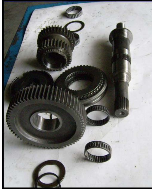
Fig. 4. Detalle de algunos engranajes de la transmisión. (Fuente propia)
